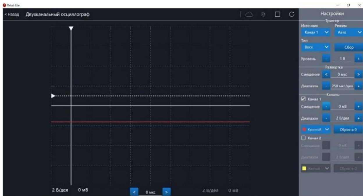
Рис. 40. Сигнал с ненулевым смещением
