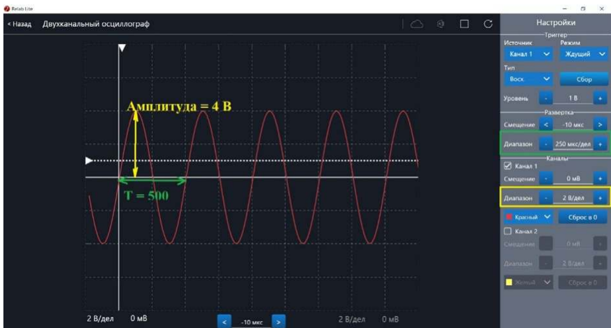
Рис. 42. Определение параметров осциллограммы
