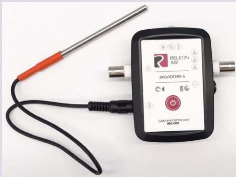
Рис. 6. Датчик температуры растворов
