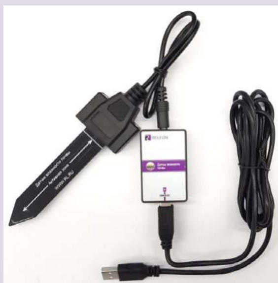
Рис. 4. Датчик влажности почвы
